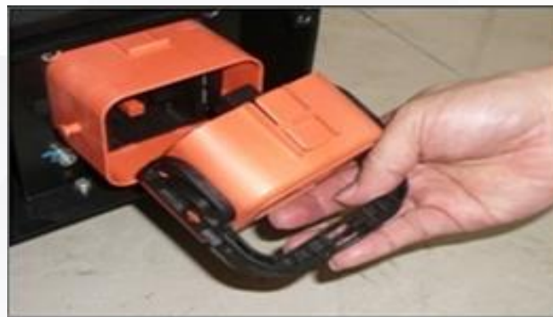
④拉出高压开关
